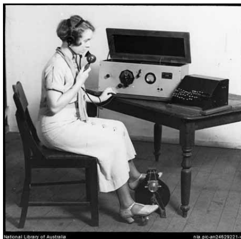
Фотография из архива Национальной библиотеки Австралии. Педальное радио с голосовой функцией 4
